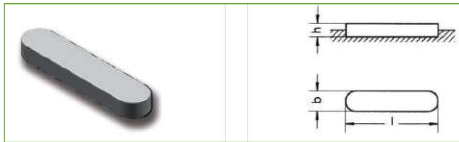
Figura 4.17: Chaveta prismática selecionada da OpaC. Fonte: Adaptado de (Catálogo OpaC, 2025)
