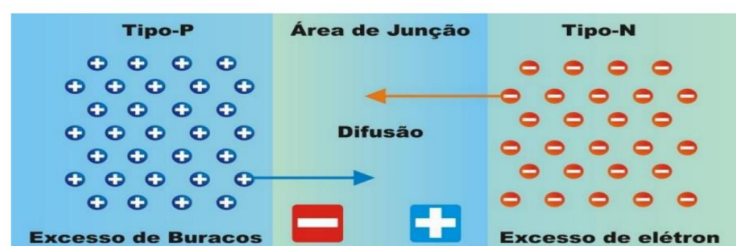
FIGURA 3. DIFUSÃO DOS ELECTRÕES NA JUNCTÃO P-N. [FONTE: OLIVEIRA, 2023]
