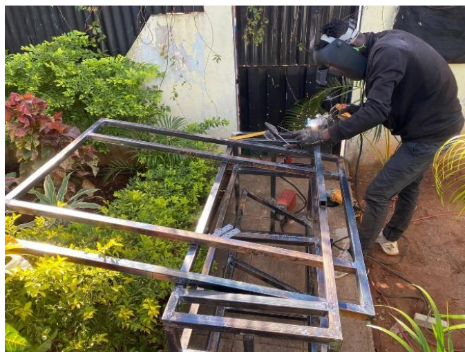
FIGURA 45. PROCESSO DE SOLDADURA DE TUBOS METÁLICOS, SEGUIDO PELA APLICAÇÃO DA PINTURA NA ESTRUTURA. [FONTE: AUTOR 2024]
