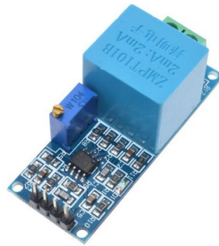
FIGURA 26. SENSOR DE TENSÃO AC 0-250V ZMPT101B. [FONTE: OLIVEIRA, 2019 ]
