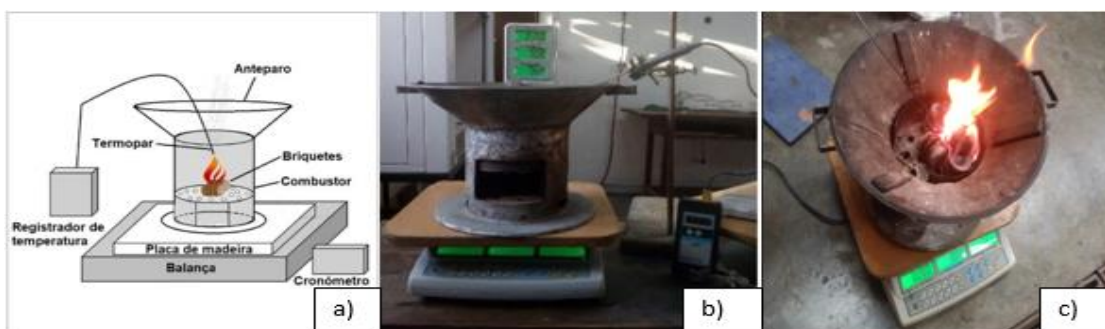
Figura 18: Esquema do sistema para determinação das variáveis do ICOM (a); Sistema de ICOM montado (b); Briquetes em combustão (c). Fonte: Elaborado pelo autor.
