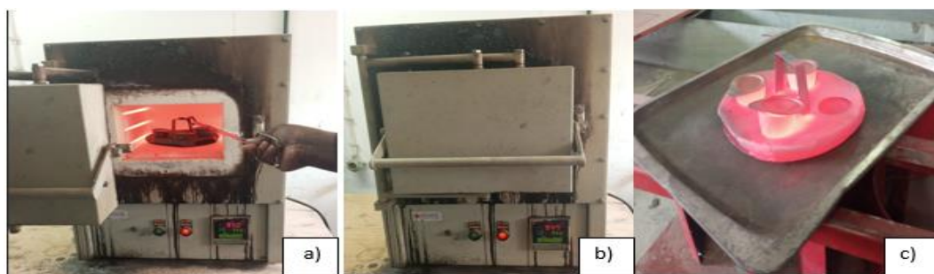
Figura 15: Cadinhos a serem introduzidos na mufla (a); Mufla fechada após a introdução dos cadinhos (b); Cadinhos a resfriarem ao ar livre após a retirada na mufla (c). Fonte: Elaborado pelo autor.
