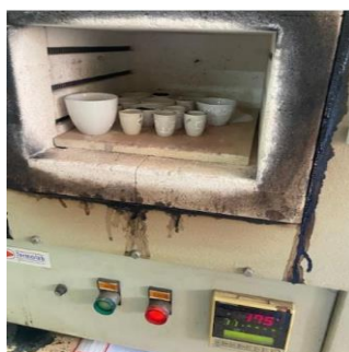
Figura 14: Mufla com os cadinhos para determinação do teor de cinzas. Fonte: Elaborado pelo autor.
