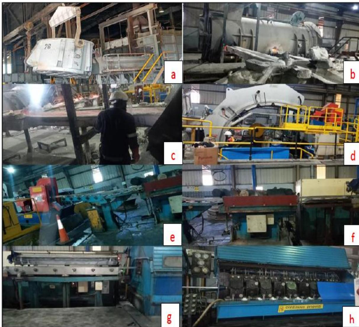
**Figura 5:** Principais equipamentos usados para obtenção do varão do alumínio. **a)** Panela metálica. **b)** Forno secundário. **c)** Caneletes metálicas. **d)** Roda de fundição. **e)** Tesoura principal. **f)** Roda de fundição. **g)** Máquina de indução de calor. **h)** Máquina de extrusão secundária.
