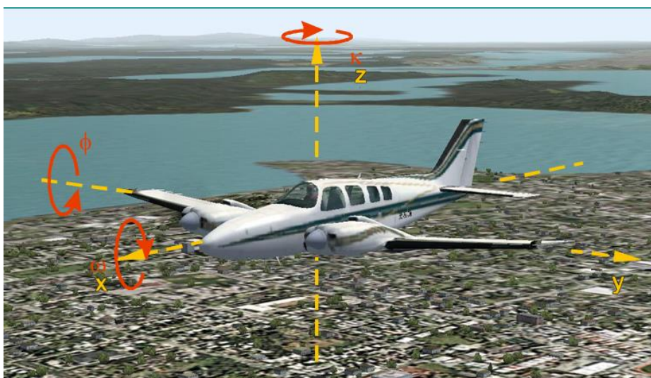
Figura 10. Movimentos da aeronave durante o voo – Ângulos de atitude (Fonte: Universidade Católica de Pernambuco, 2018)
