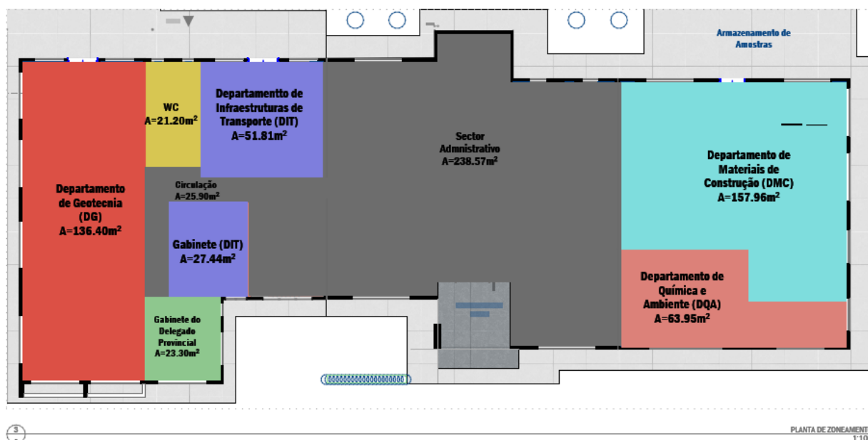
Figura 4: Zoneamento/ áreas de distribuição segundo a estrutura organizacional para Delegações Provinciais.
