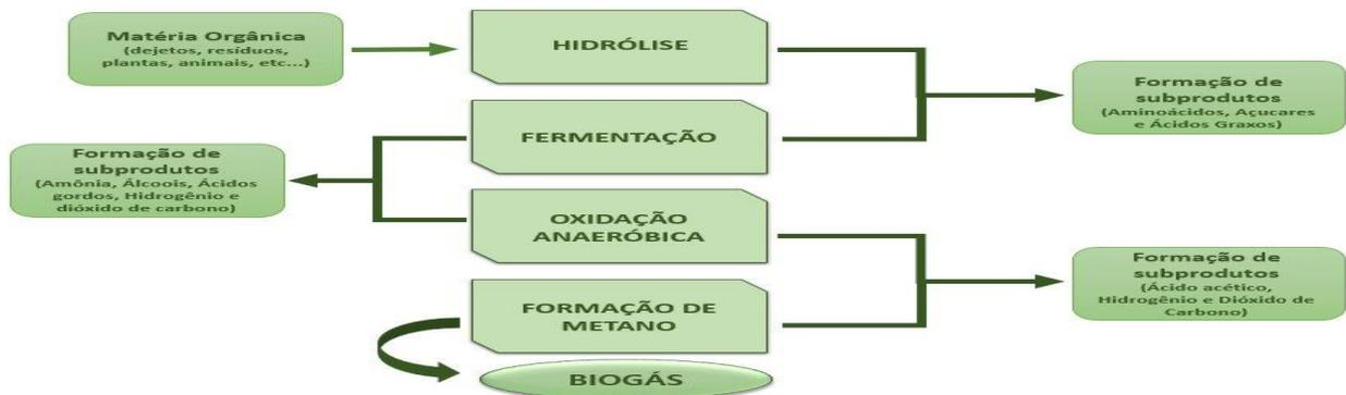
Figura 3, Apresentação esquemática do processo de digestão anaeróbica Fonte: [www.infoescola.com](http://www.infoescola.com)
