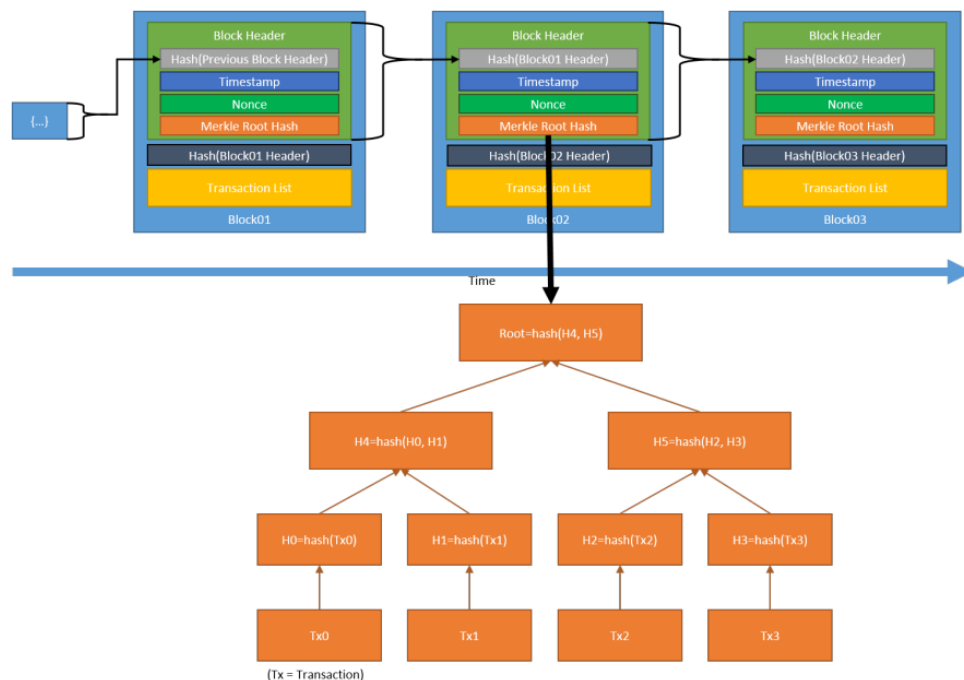
Figura 4: Transacções com Hash em uma Merkle Tree
