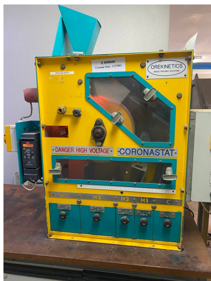
Figura 21: Rolo de alta tensão utilizado.
