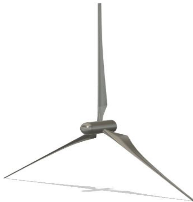
Figura 2: Representação do rotor de uma turbina de eólica de eixo horizontal (HAWT) com as respectivas pás.
