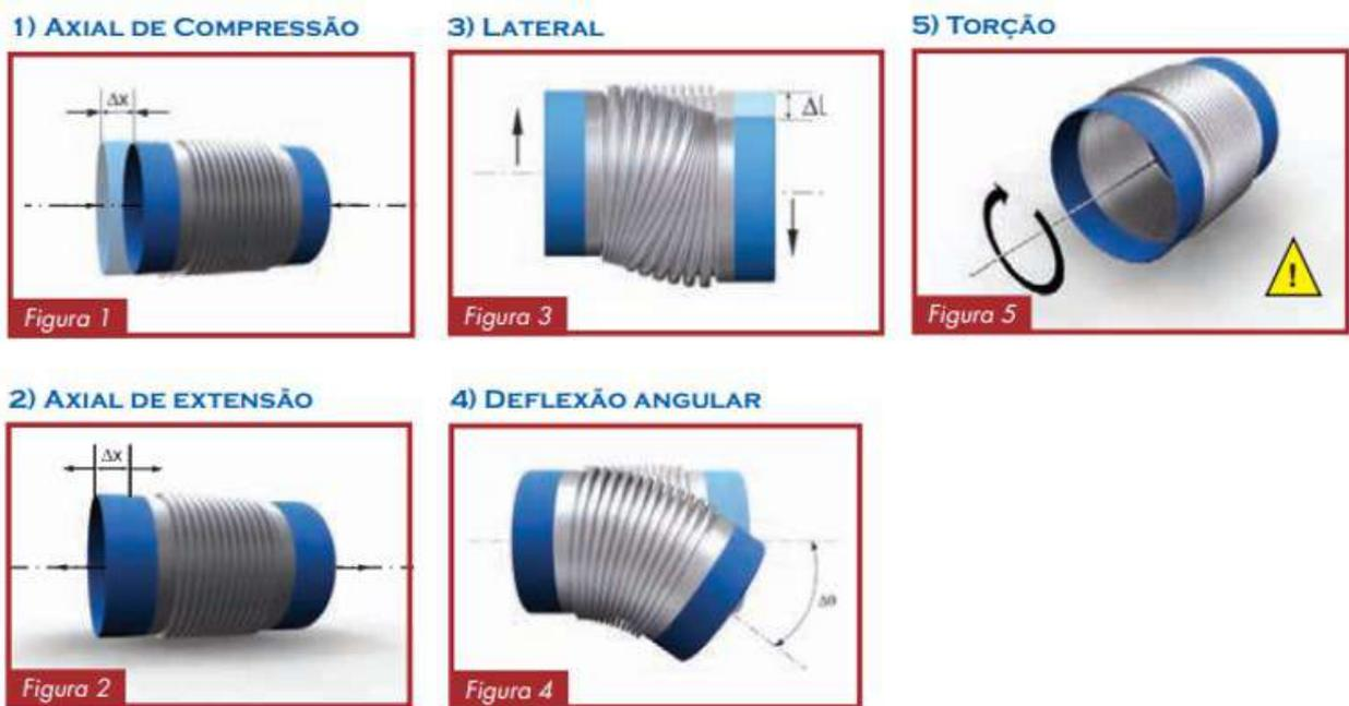
Figura 21: Movimentos da junta absorvedora de vibrações.
