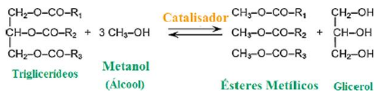
Figura 4: Reacção de transesterificação com metanol e com catalisador básico. (Fonte: Silva, L., 2014)
