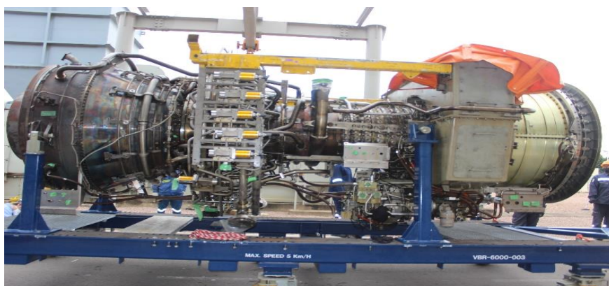
Figura 3- Turbina a gás de modelo LM6000PF da CTM.
