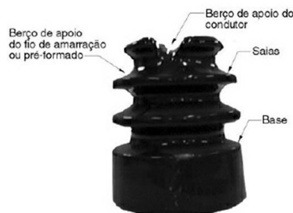
Figura 16: Isolador de pino em porcelana [6]
