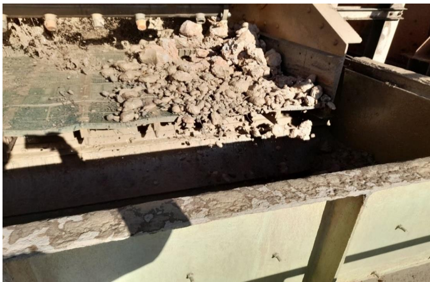
Figura 10: Características das partículas extraídas nas unidades litológicas durante a classificação granulométrica
