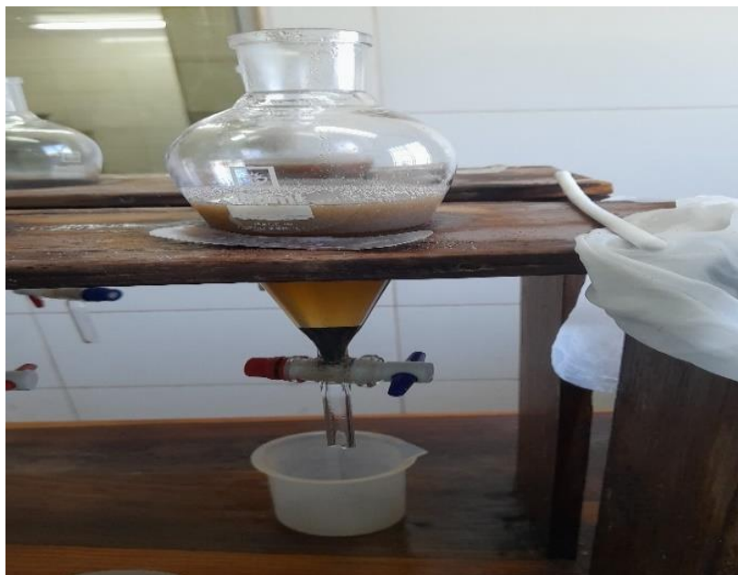
Figura 5: Separação gravítica por meio de LST
