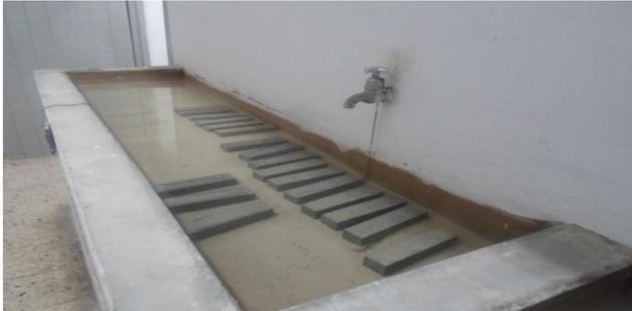
**Figura 2:** Corpos de prova na sala de cura
