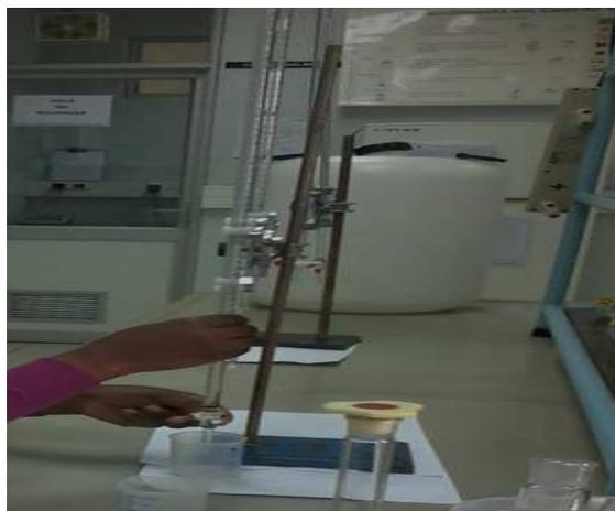
**Figura0I:** Titulação da solução obtida pelo hidróxido de sódio
