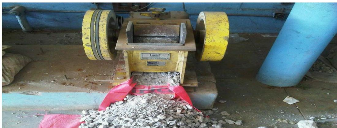
Figura 4 - Preparação das amostras com britadeira eléctrica
