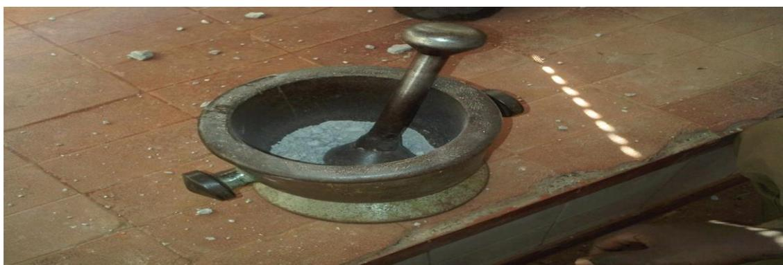
Figura 5 - Preparação das amostras com triturador manual
