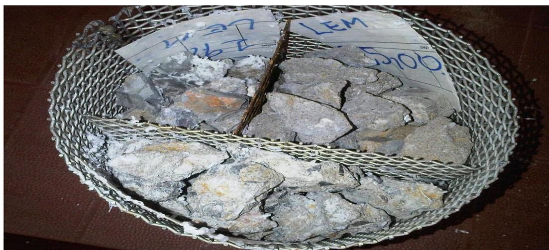
Figura 9 - Amostras após secagem na estufa a 105°C durante 4 horas
