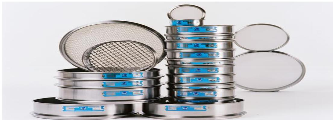
Figura 6 - Peneiros usados na preparação das amostras para diferentes granulometrias
