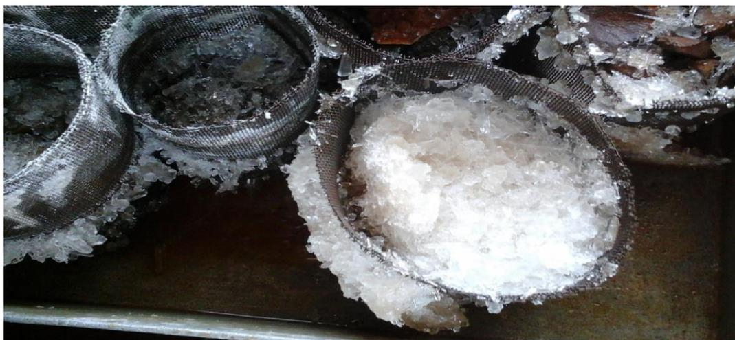
Figura 8 - Amostras após imersão em sulfato de sódio a 21°C durante 16 a 18 horas
