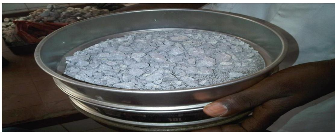
Figura 7 - Preparação das amostras em diferentes granulometrias
