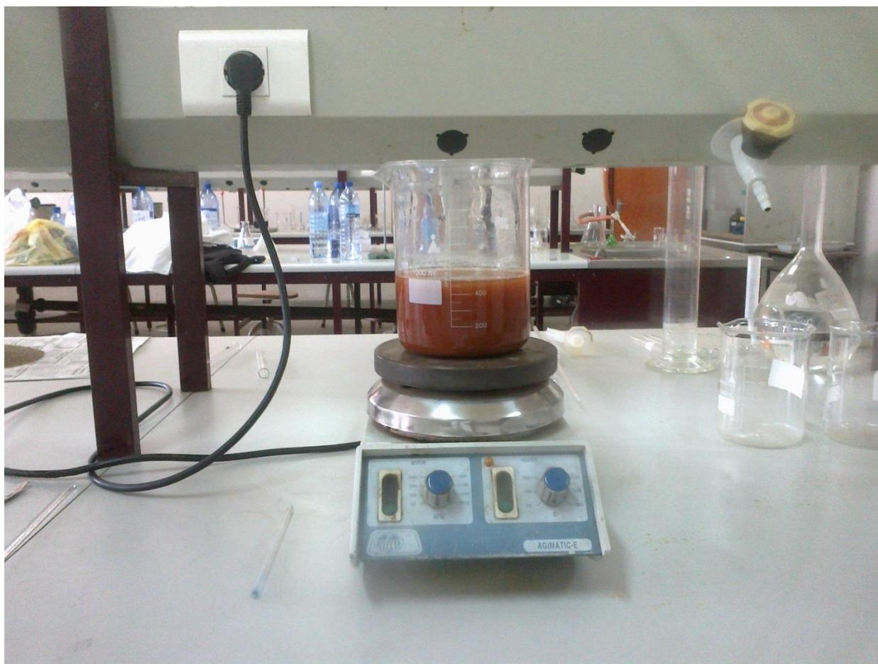
Figura 4-Processo de activação ácida da argila mediante a agitação magnética constante a 400 rpm.
