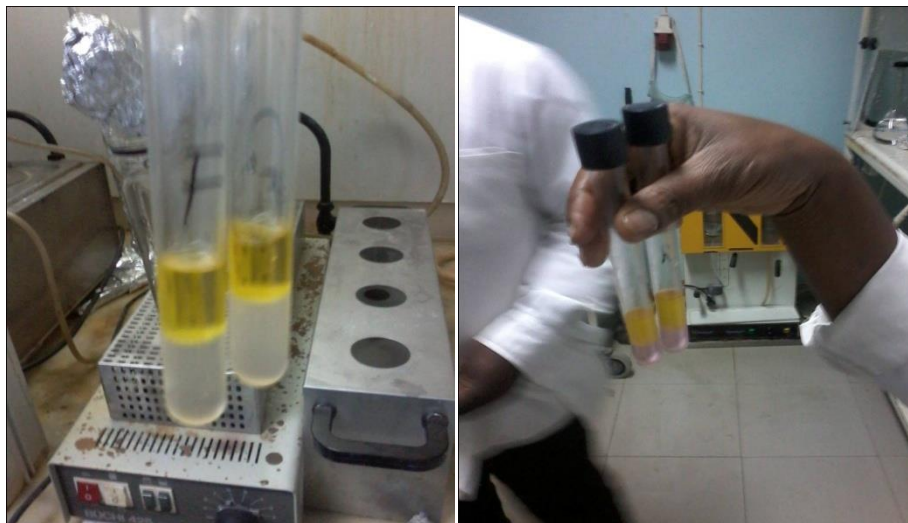
Figura 5. Resultados do teste qualitativo de Kreiss.
