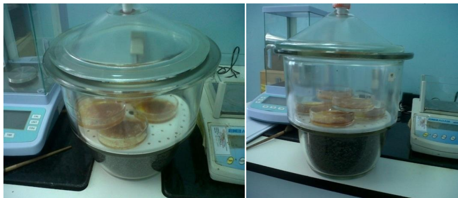
Figura 4. Cápsulas contendo areia retiradas da estufa para exsiccador.
