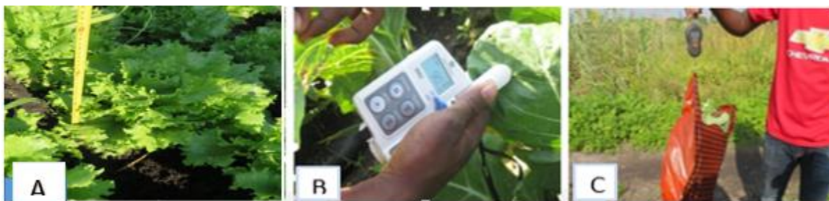
Figura 4. Medição do diâmetro e número de folhas (A); medição do teor de clorofila (B); medição do peso fresco (C).
