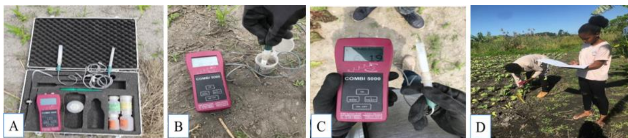
Figura 3. Aparelho portátil COMBI 5000 (A); calibração do aparelho COMBI 5000 (B) medição e registo do pH e da CE 1: 2.5 (C) e (D).
