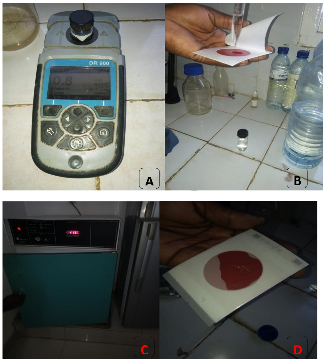
Figura 8: Instrumentos usados nas análises laboratoriais ((A) Espectrofotómetro, (B) Garrafas contendo amostras e alguns reagentes, (C) Estufa e (D) Placa de Petrifilm).
