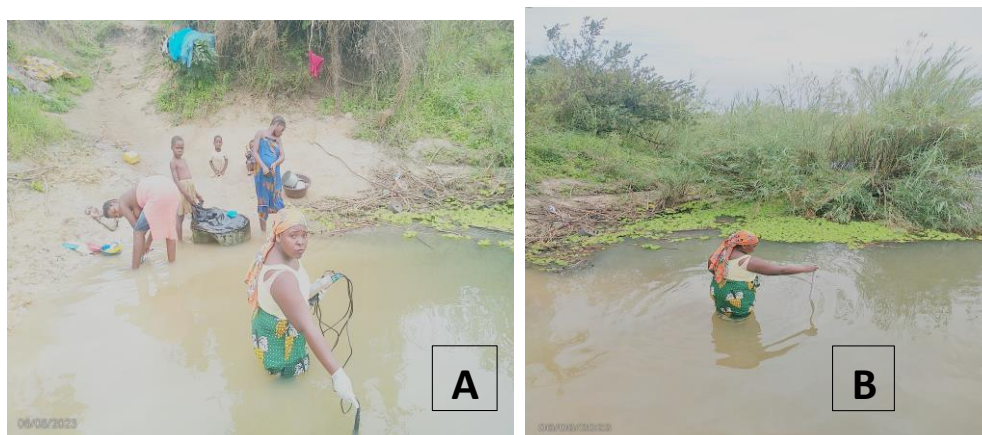
Figura 10: Medição de parâmetros físico-químicos no campo A (temperatura, salinidade, O. Dissolvido e pH), B (transparência).
