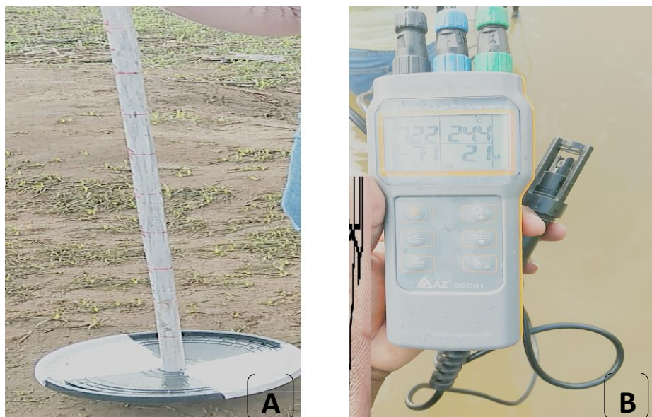
Figura 9: Instrumentos de medição usados no campo A (Disco de Secchi) e B (Multi Parâmetro)
