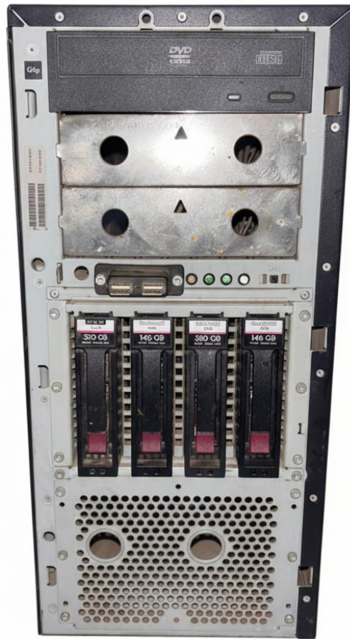
Figura 28 - Servidor usado para testes de carga
