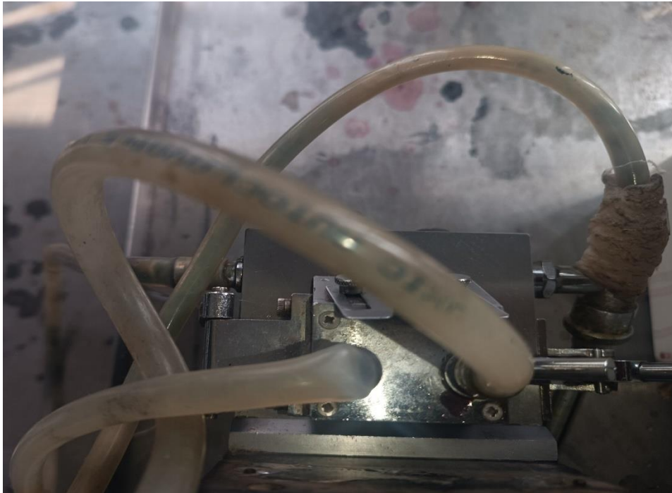
Anexo 18: Fechamento da lâmina de cobertura do refractómetro para o procedimento da determinação do °Brix.
