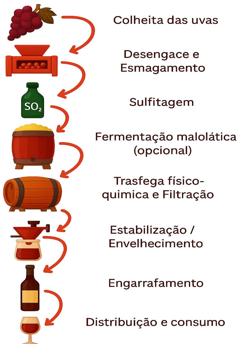
Figura 4: Etapas do processo de fabricação do vinho.
