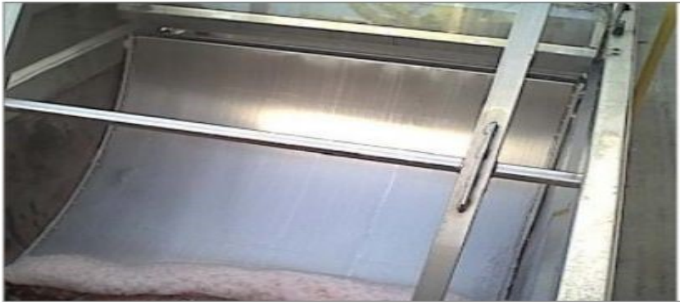
Figura 2: Ilustra uma peneira rotativa (In: CARREIRA, 2006).
