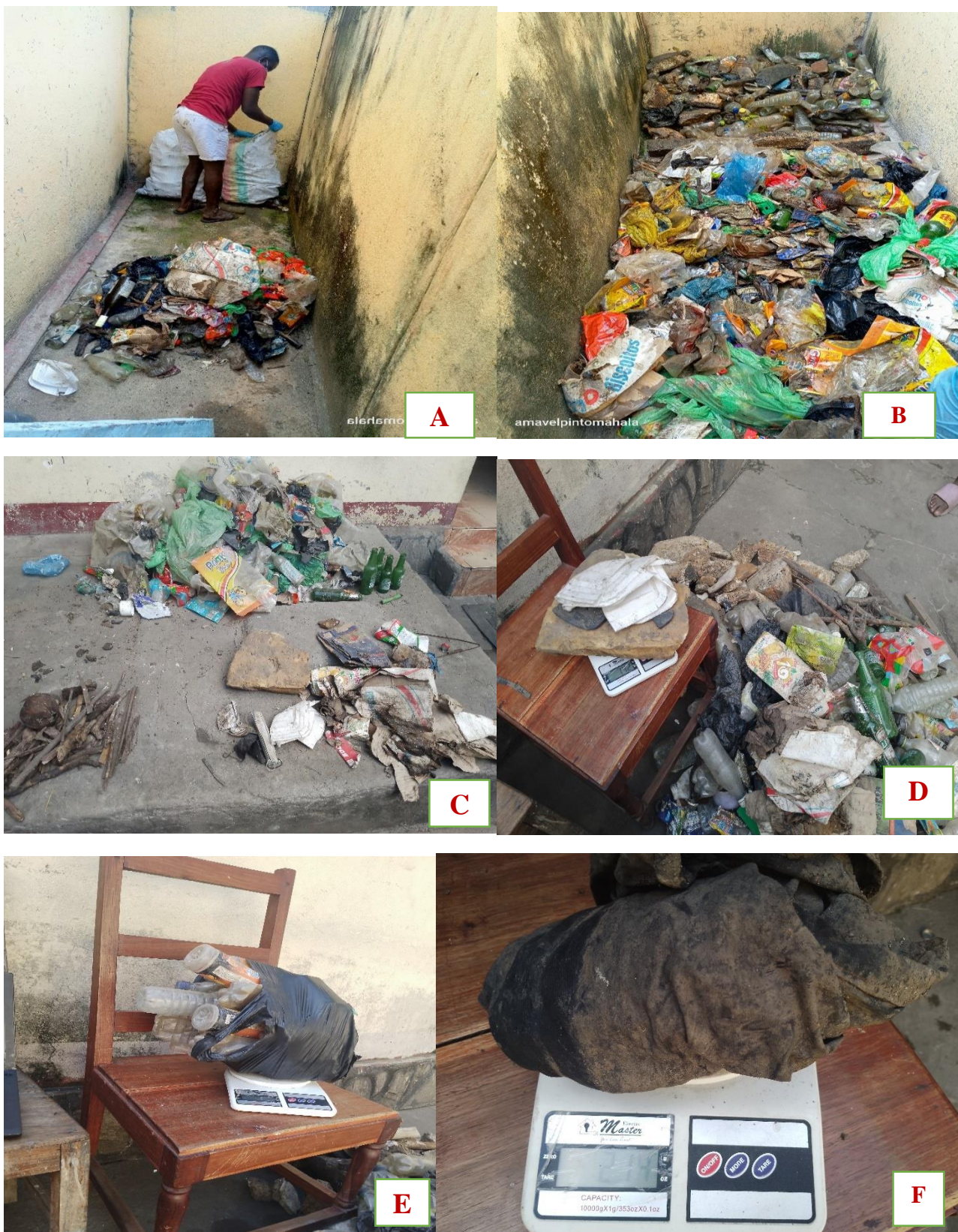
Figura 15: Etapas do processamento das amostras coletadas; imagens A e B representam o processo de secagem das amostras, imagem C mostra o processo de separação e contagem dos RS e imagens D, E e F ilustram o momento de pesagem das amostras para análise. Fonte: Autor (2024).
