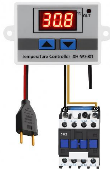
Figura 17: Termostato ligado a um contactor; Fonte: (RoboBuilders, 2025)
