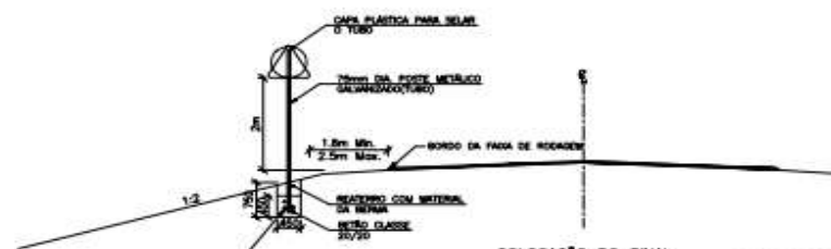
COLOCAÇÃO DO SINAL ESCALA 1:30
