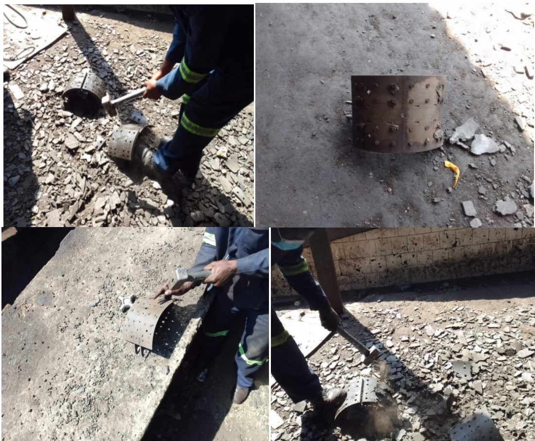
Figura 13: Retirada da lona no patim de freio
