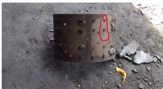
Figura 14: Sistema de Fixação das Lonas nos Patins
