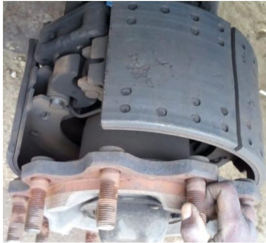
Figura 4: Sistema de freio do autocarro com tambor de freio desmontado
