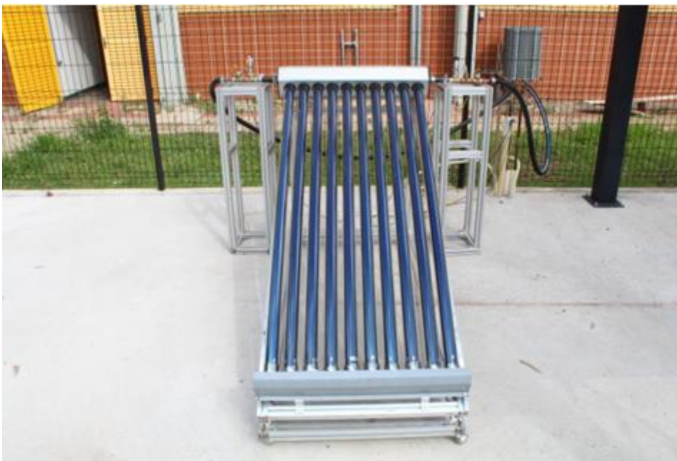
Figura 4-Colector solar de tubos evacuados (BASILIO, 2021)
