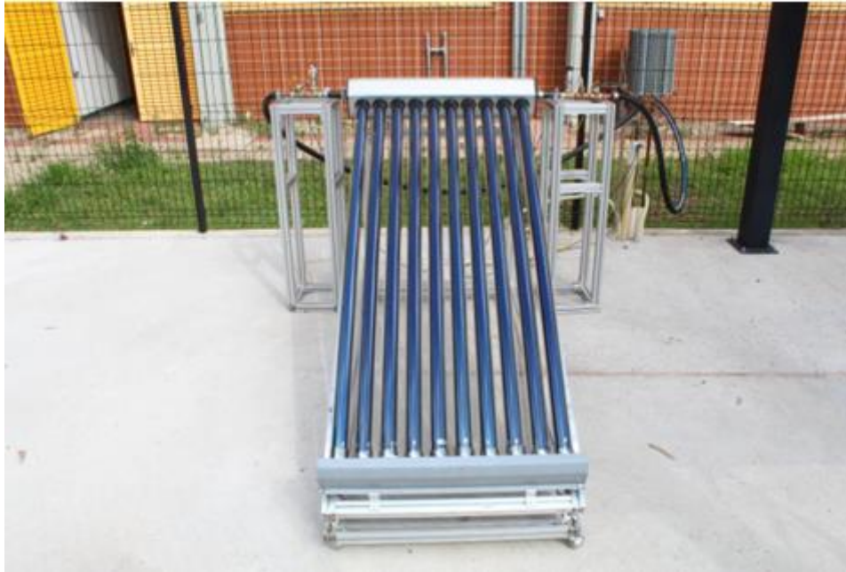
Figura 13- Colector solar de tubos evacuados (BASILIO, 2021)
