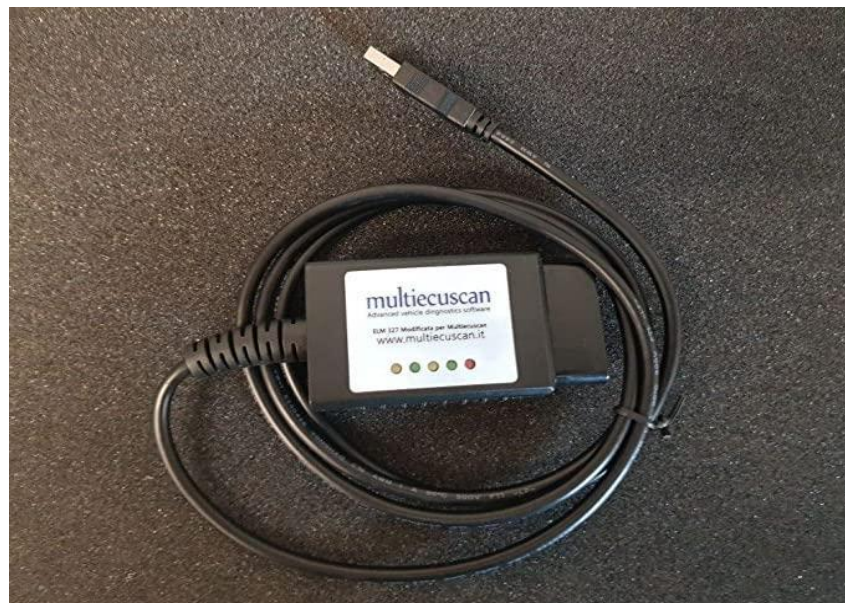
Figura 11. Scanner Multiecuscan usada nas simulações. Fonte: Autor, 2025.
