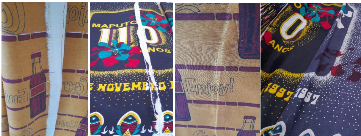
Imagem 5. 5: Defeitos do tipo ligação. Fonte: Autor.
