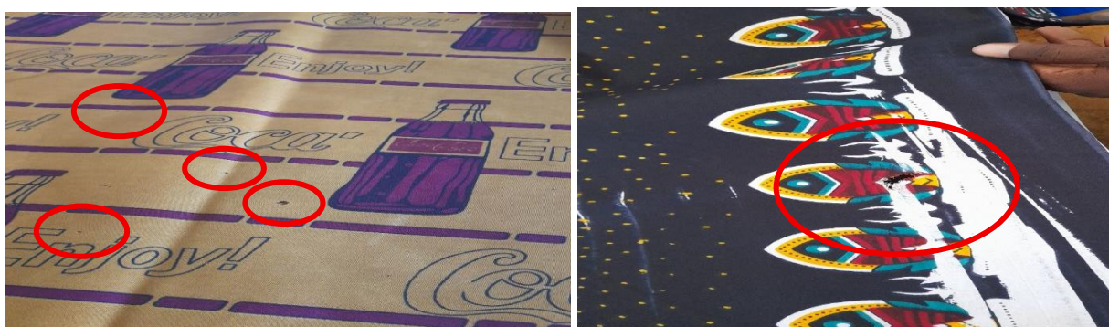
Imagem 5. 1: Defeitos do tipo furo. Fonte: Autor.
