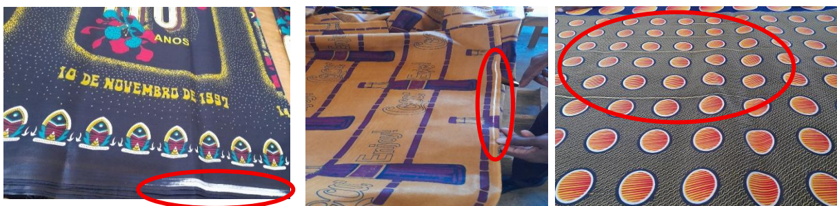
Imagem 5. 2: Defeitos do tipo riscas. Fonte: Autor.
