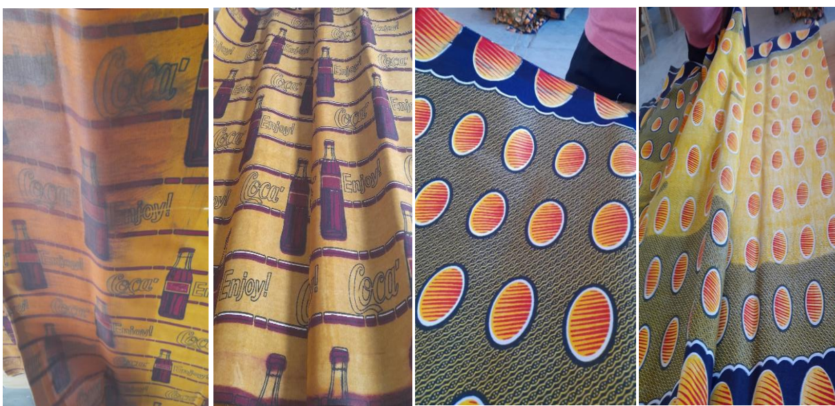
Imagem 5. 4: Defeitos do tipo tonalidade na pintura. Fonte: Autor.
