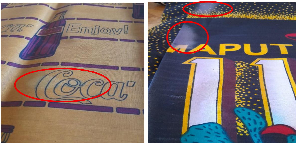
Imagem 5. 3: Defeitos do tipo manchas. Fonte: Autor.
