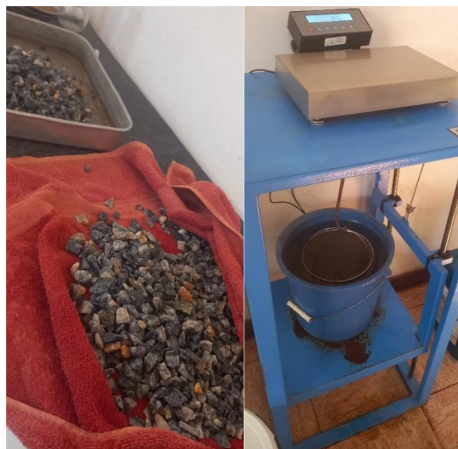
Figura 22. Processo de secagem da superfície dos agregados e pesagem dos agregados na água.
