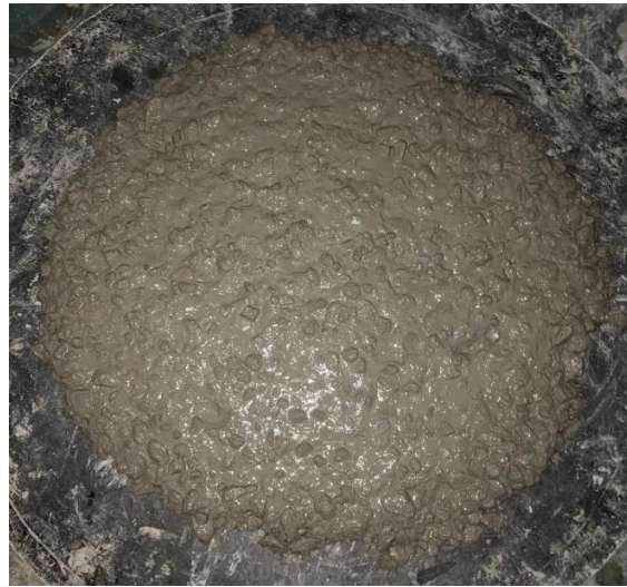
Figura 26. Aspecto visual do betão da família 4 no ensaio de espalhamento.
