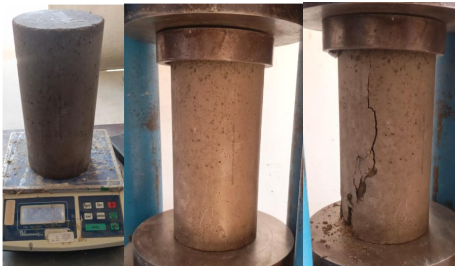
Figura 29. Ensaio da resistência à compressão do BAC.
