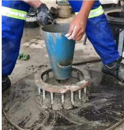
Figura 27. Amostra de betão passando por armaduras no teste de J-ring.
