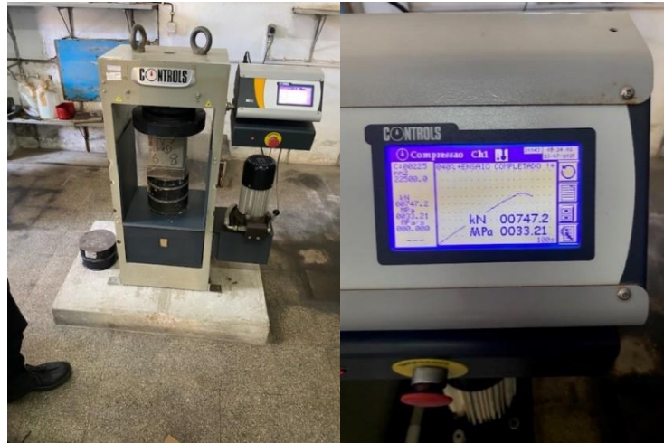
Figura 45. Ensaio de Resistência de cubos de Betão
