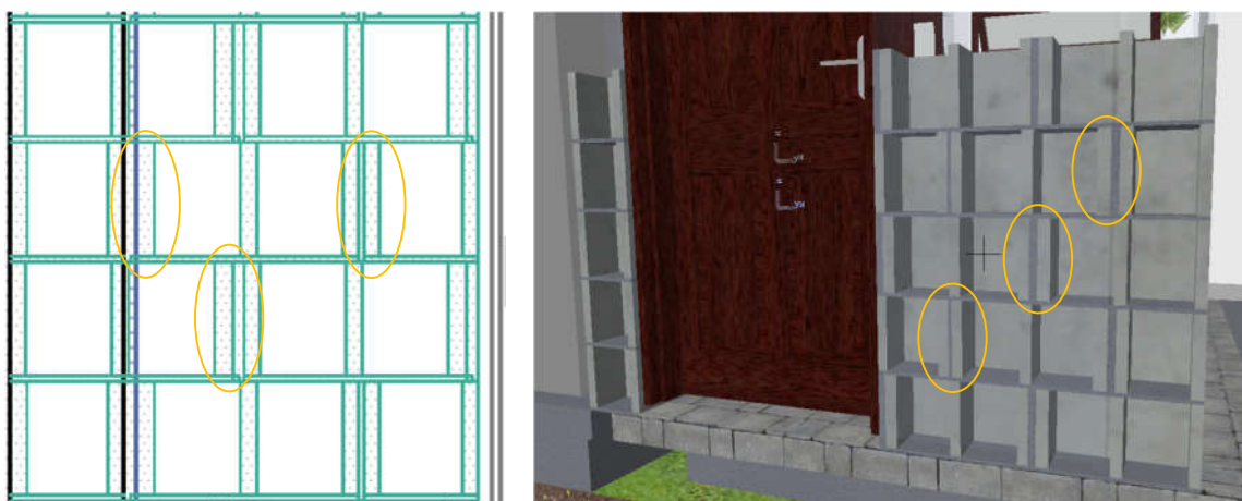
Figura 3-32: Modulação inadequada dos blocos.
