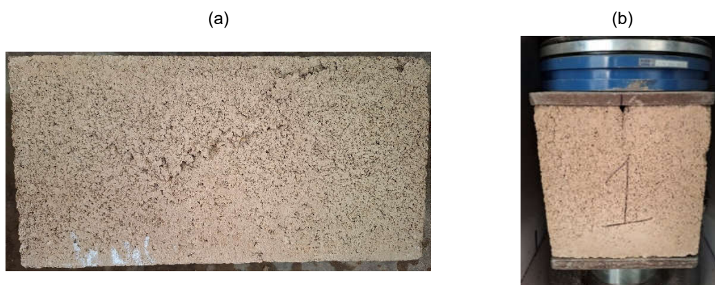
Figura 3-7: Blocos ensaiados à compressão.
