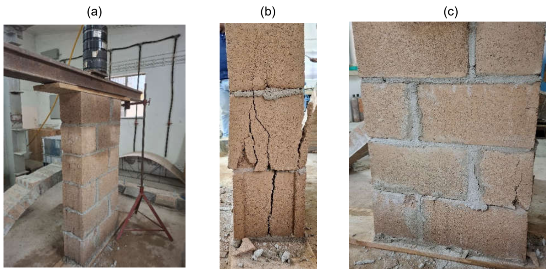
Figura 3-27: Rotura da parede 2 com 120 cm de altura após o ensaio de compressão.
