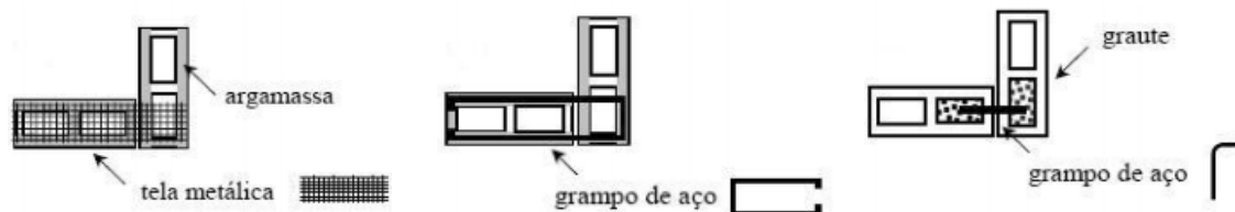
Figura 2-10: Tela metálica e grampo, (Pastor 2007).
