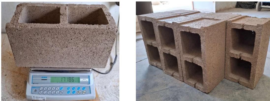
Figura 3-6: Pesagem dos blocos.
