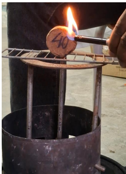
Figura 36: (à esquerda) Teste de ignição em um bríquete simples de 40 gramas
