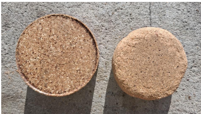
Figura 33: Briquete produzido com dimensões-padrão (à esquerda) do molde e briquete com diâmetro reduzido manualmente (à direita)
