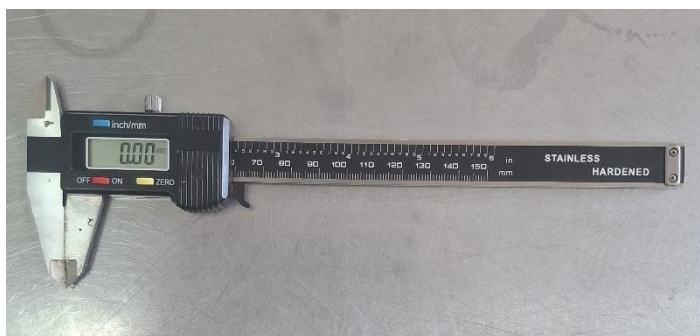
Figura 12: Paquímetro digital (marca: Mitutoyo; modelo: CD-6" CSX)
