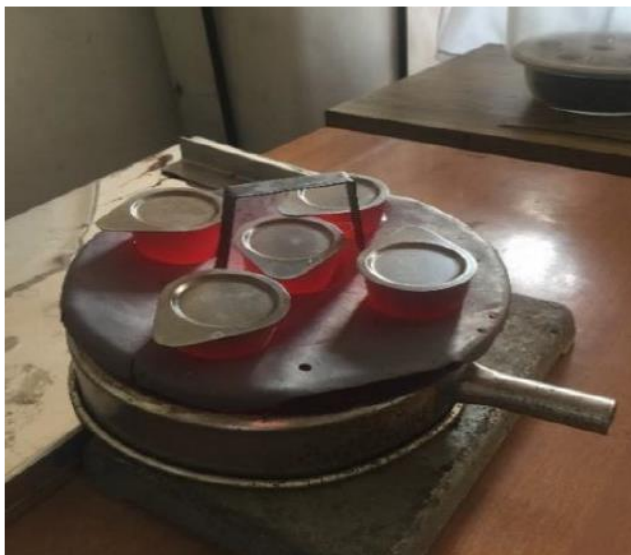
Figura 15: Cadinhos metálicos retirados da mufla após o teste de voláteis
