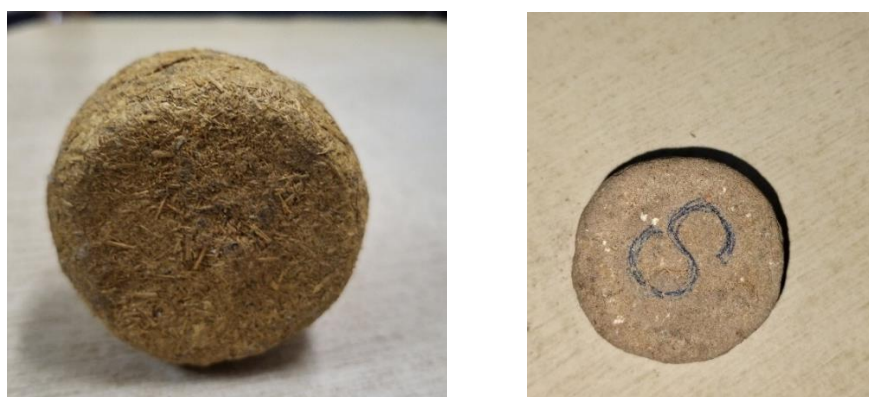
Figura 34: Briquetes com camada de cobertura adicionada nitrato de celulose simples (a esquerda) e nitrato de celulose residual (a direita)
