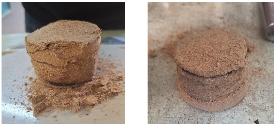
Figura: 31: Briquete desfeito após tentativa de cobertura por briquetagem a frio
