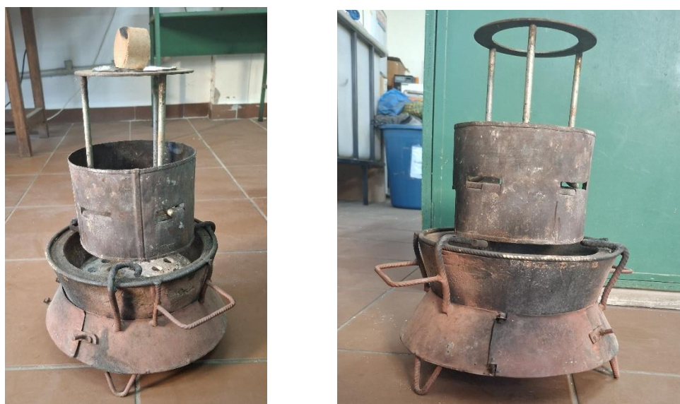
Figura 35 e: Suporte de ignição adaptado para o teste de ignição
