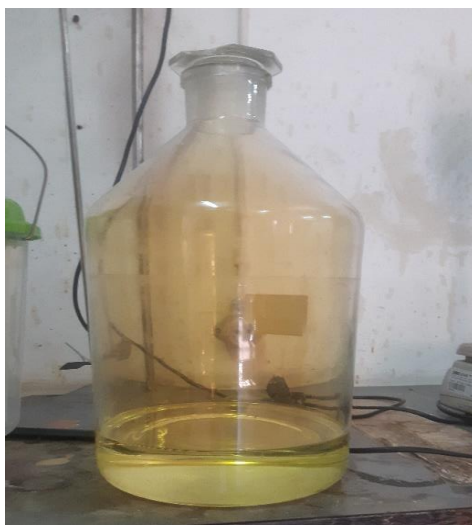
Figura 27: Mistura Sulfonítrica preparada no balão de 10L
