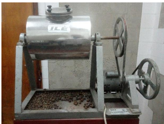
Figura 11: Moinho de bolas usado para realizar o ensaio de friabilidade (Fonte: (Matos, 2021))
