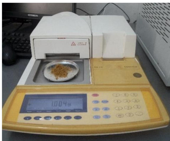
Figura 10: Analisador de Humidade (Sartorius MA 100)
