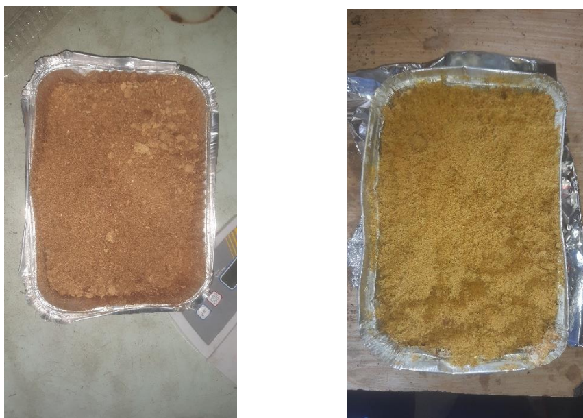
Figura 29: Nitrocelulose simples (à esquerda) e residual (à direita) após a secagem
