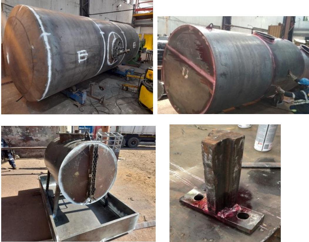
Figura 18 - Teste de soldadura por líquidos penetrantes e por partículas magnéticas(Fonte: TRI-M)
