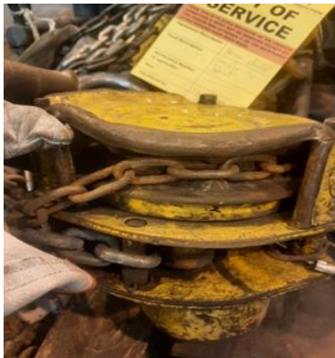
Imagem 6: Talha com a tampa amolgada
