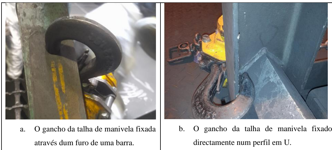
Imagem 4: Ancoramento inadequado de talhas de alavanca praticada por alguns utilizadores
