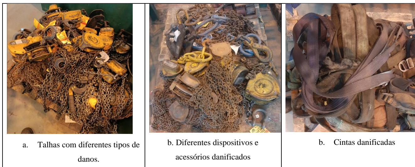
Imagem 3: Diversos dispositivos de elevação danificados durante a utilização na planta
