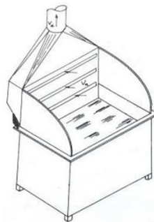
Figura 20 – Sistema fixo com captor de fenda lateral (Fonte: Macintyre, 1990)
