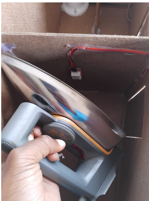
Figura 4.4: Sensor DHT22 sendo aquecido com base em um ferro de passar roupa.
