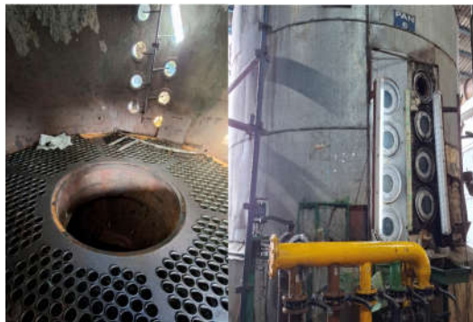
Figura 17: O Interior e o exterior de uma panela em uso na TH ADM [Autor]
