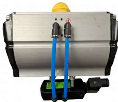
Figura 23: Válvula solenoide acoplada no atuador pneumático [Autor]
