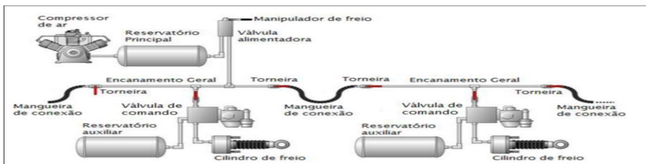
FIGURA 6. REPRESENTAÇÃO ESQUEMÁTICA DO SISTEMA DE FREIO AUTOMÁTICO, (BERGANTINI, 2011)
