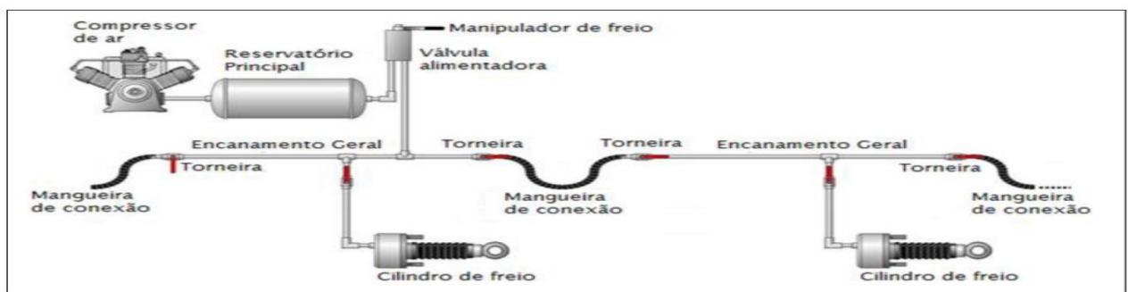
FIGURA 5. REPRESENTAÇÃO ESQUEMÁTICA DO SISTEMA DE FREIOS A VÁCUO (BORBA, 2011)
