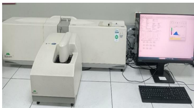
Figura 24: Analisador de granulometria por difracção a laser.
