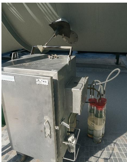
Figura 18: Processo de amostragem do gás de entrada.
