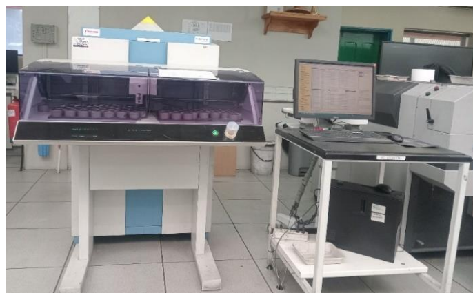
Figura 28: Espectrómetro de Fluorescência de Raios-X.
