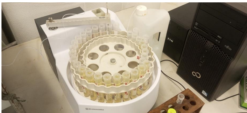
Figura 6 - Leitura das amostras em ICP-OES.
