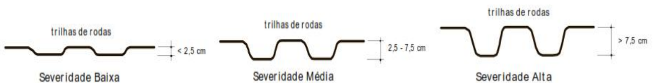
Figura nº 6 Afundamento trilhas de rodas severidade baixa, média e alta
