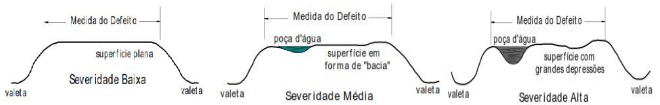
Figura nº 4 Secção transversal inadequada severidade baixa, média e alta
