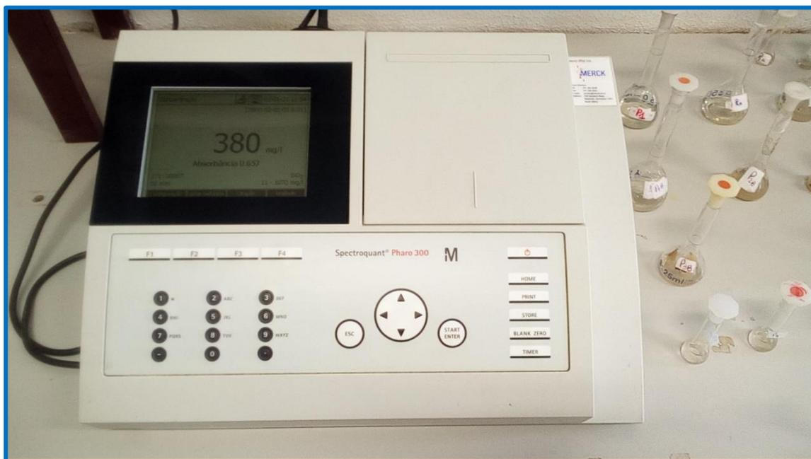
**Figura 6:** Espectrofotômetro usado para determinar as concentrações da sílica nos sedimentos.
