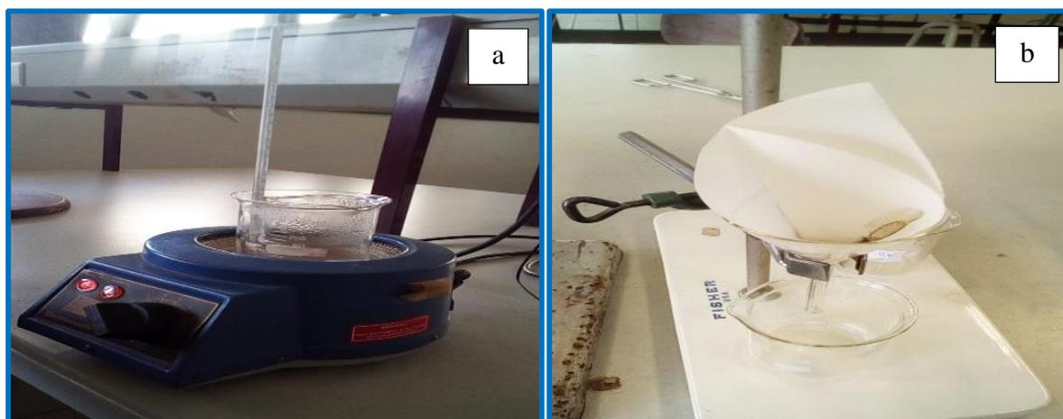
**Figura 5:** Manta elétrica com o copo de Becker e termômetro para controle da temperatura (a) e o processo de filtragem das amostras (b).
