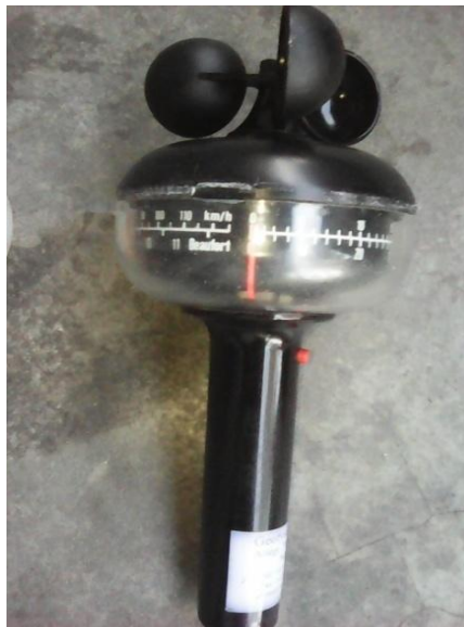
Figura 9 Anemómetro usado para medição de vento. Fonte: Autor
