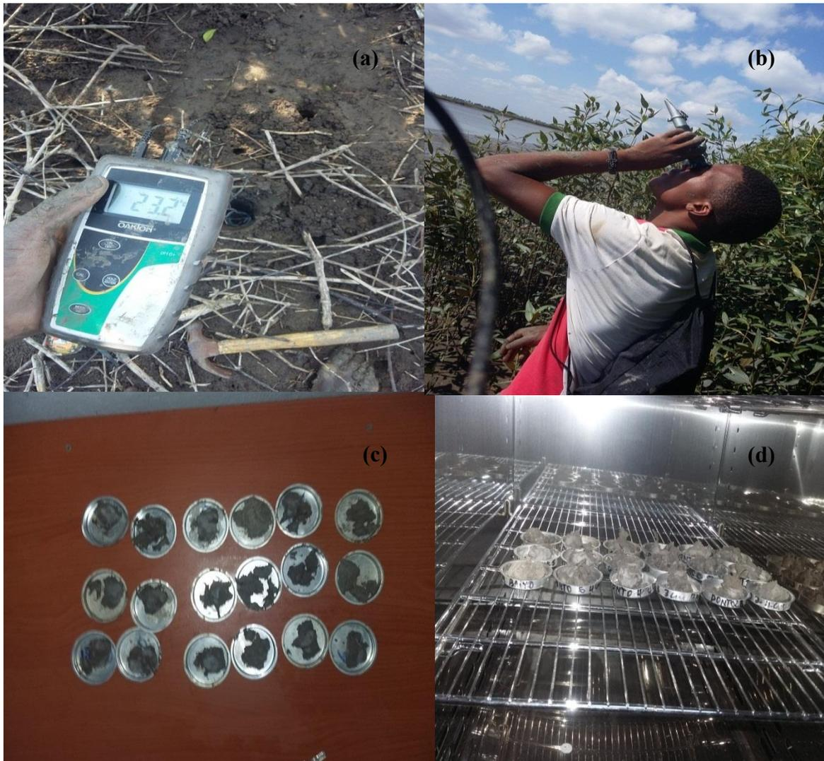
**Figura7.** Medições directas no campo de ph com phmetro (a) e salinidade com refratômetro (b), cápsulas laboratorias contendo amostras de solo (d), estufa na secagem de amostras de solo contidas nas cápsulas.
