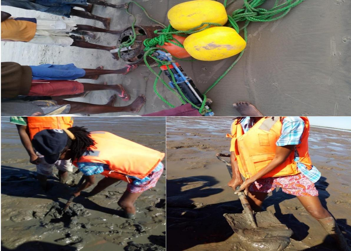
**Figura 3:** Pá usada para a colheita das amostra e o CTD para a determinação das marés
