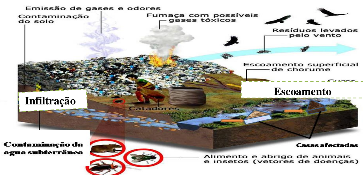
Figura 2: Esquemática do processo de contaminação da água subterrânea por resíduos sólidos depositados no solo.
